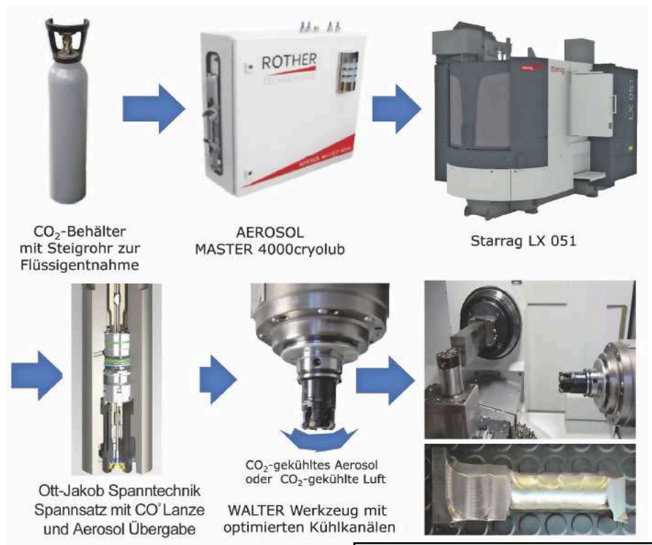
Optimal konfiguriertes kryogenes Zerspansystem Bild: FTZ
