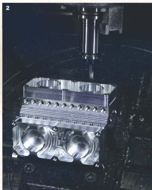
1 Der Aerosol Master ist das Steuergerät der ATS und ATS mit Cryolub. 2 Performancesprünge macht die Aerosol-Trockenschmierung bei der Aluminiumbearbeitung möglich.
