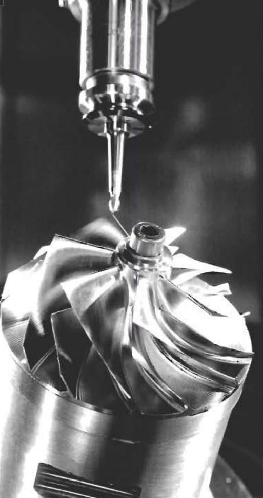
**V**iele moderne Hightech-Materialien wie etwa Duplex-Stähle, Titan oder Superlegierungen haben eine schlechte Wärmeleitfähigkeit. Die hohe Prozesswärme bei der Bearbeitung wird daher nicht über den Span abgeführt, sondern verbleibt in der Zerspanungs-Kontaktzone, was schnell zu sehr starken Verschleißerscheinungen an der Werkzeugschneide führt. Die Lebensdauer auch von teuren Hochleistungspräzisionswerkzeugen ist so relativ niedrig.
